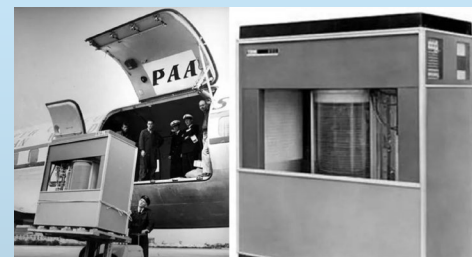
IBM 305 RAMAC磁盘机。总存储容量：4.4MB（1956）
